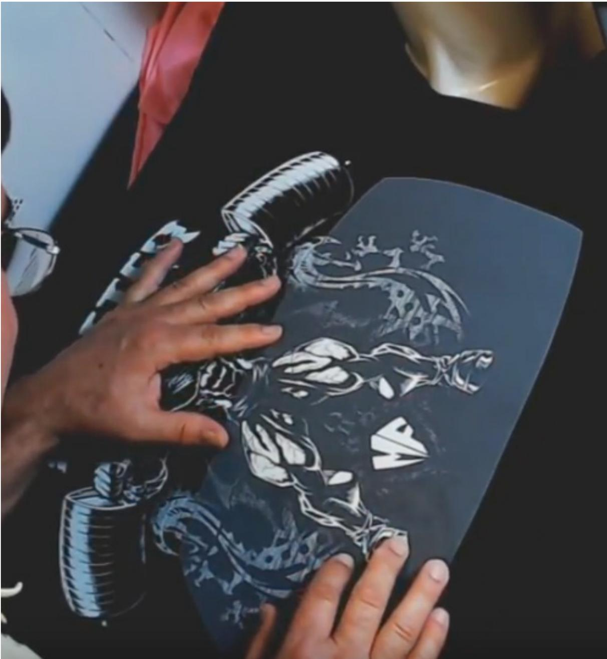
Abkühlen lassen und vorsichtig trennen. Anschließend wird das endgültige Design mit einem Pergamentblatt unter dem höchsten empfohlenen Druck für die gesamte empfohlene Zeit gepresst, um beide Teilmotive mit dem Textil zu verschmelzen
